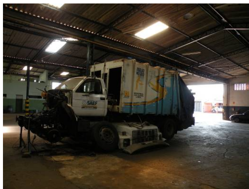
Figura 324 – Caminhão coletor-compactor do SAEF em manutenção.
