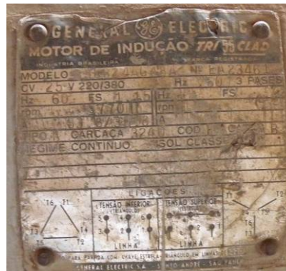
Figura 211 – Especificações do motor.
