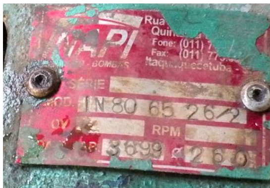
Figura 210 – Especificações da bomba.
