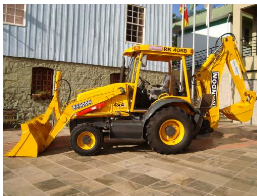
Figura 342 – Retro-escavadeira RANDON utilizada pelo SAEF nos serviços gerais dos sistemas de saneamento municipais.
