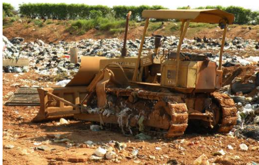
Figura 339 – Trator de esteira utilizado exclusivamente no aterro.
