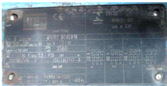
Figura 188 – Especificações técnicas do motor da bomba.
