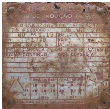
Figura 215 – Especificações do motor.
