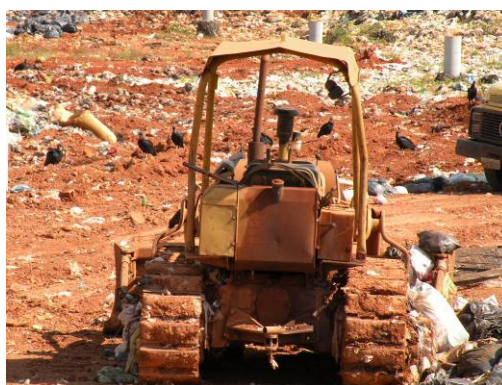
Figura 338 – Trator de esteiras utilizado para movimentação de terra e compactação do lixo nas valas do aterro.
