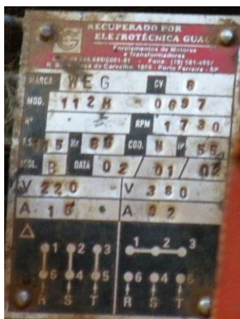
Figura 285 – Especificações da bomba menor.
