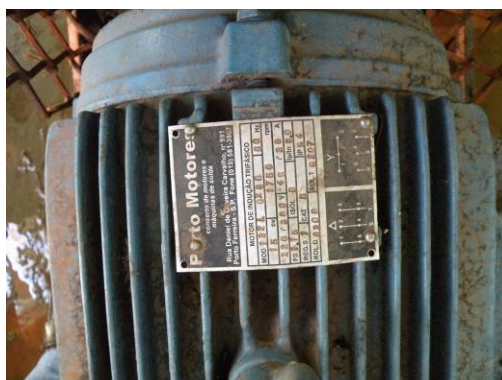
Figura 71 – Especificações do motor.
