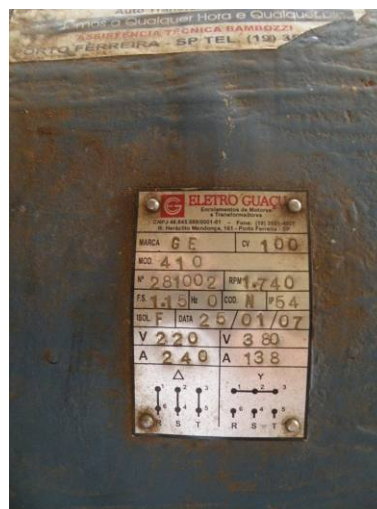
Figura 205 – Especificações do motor.
