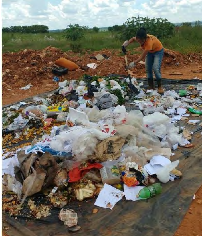
Figura 34. Aplicação do método de quarteamento
