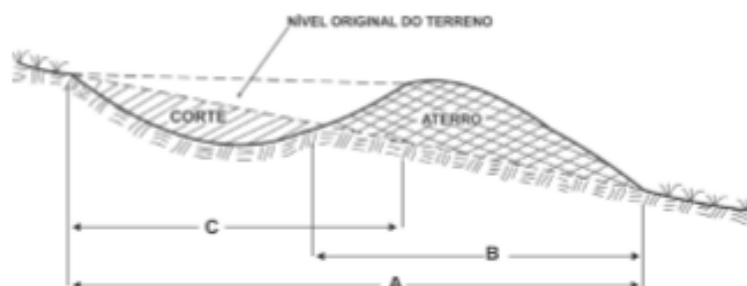
Figura 7. Representação esquemática de um terraço em perfil, mostrando: A – faixa de movimentação de terra; B – camalhão ou dique; C – o canal. Fonte: Lombardi Neto et al. (1994).
