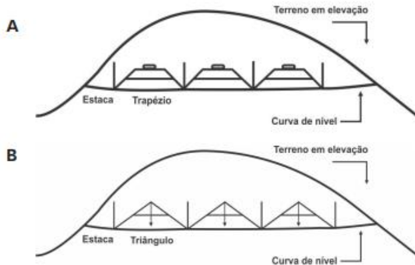
Figura 2. Locação de curvas de nível com trapézio (A) e com esquadro (B).Fonte: Macedo et al. (2009).
